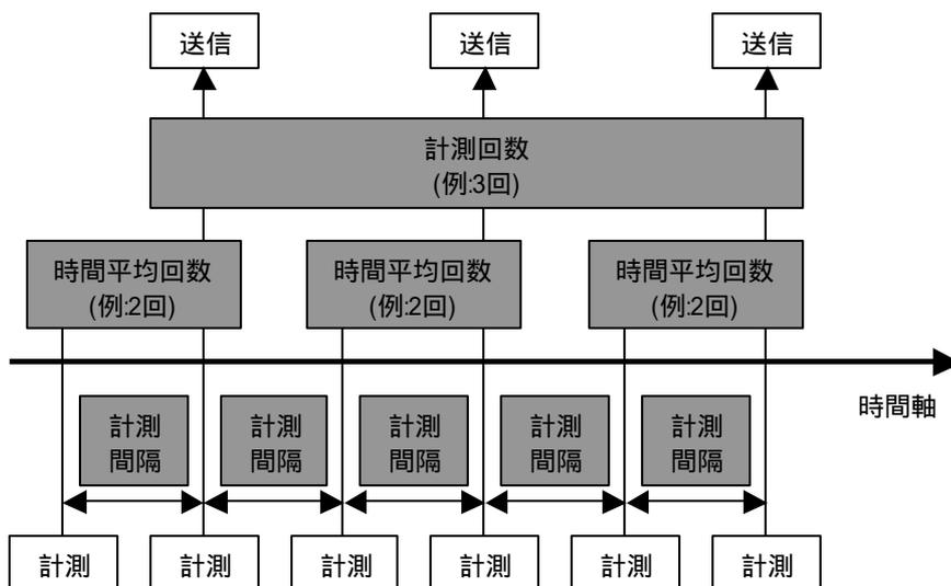
計測周期は最短で 1msec(1000Hz)、時間平均は最大で 127 サンプル、計測回数は有限回数から連続(無限)まで設定可能です。ジャイロセンサバイナリー計測の場合、データの送信間隔は最低でも 2ms(200Hz)以上の時間をあける必要があります。つまり、1ms 周期でサンプリングする場合には時間平均回数に 2 以上を指定しなければなりません。
